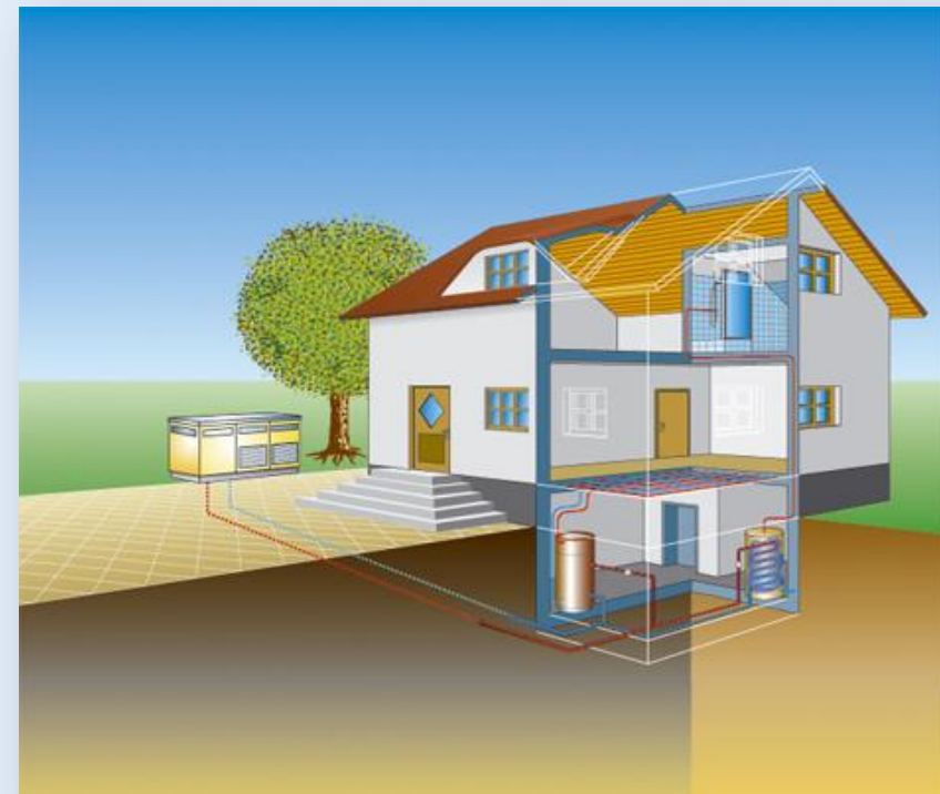
Funktionsschema Heizung mit Luftwärmepumpe und Fußbodenheizung
